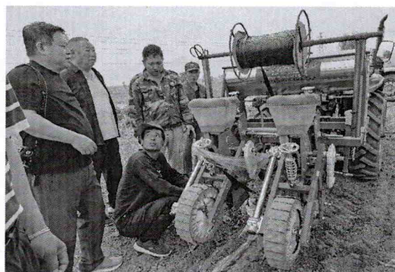
膜侧探墒沟播+膜下滴灌联合播种
