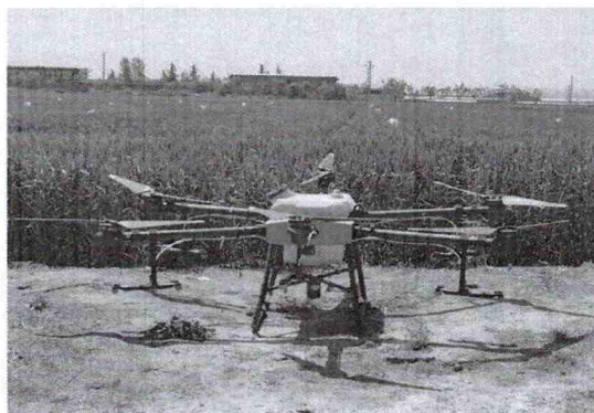
无人机一喷三防作业
